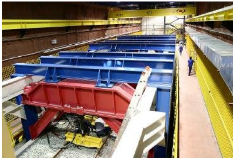
Foto 2: Cajón de ensayo de plataforma ferroviaria del CEDEX.
